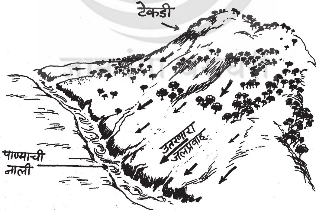
आकृती ८.१ : पाणी अडवा पाणी जिरवा अंतर्गत डोंगर पायथ्याजवळ केलेली जलवाहिका (नाली)
